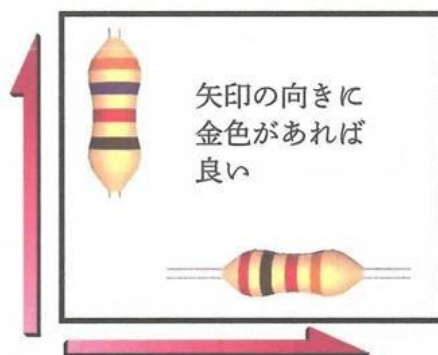
図 2 炭素被膜抵抗器の取り付け向き
