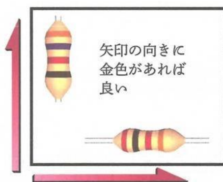
図 2 炭素被膜抵抗器の取り付け向き
