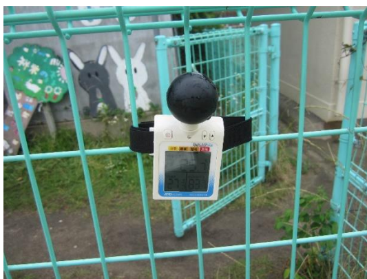
電子式暑さ指数計① 設置場所 ビオトープ(祥栄の森)のフェンス
